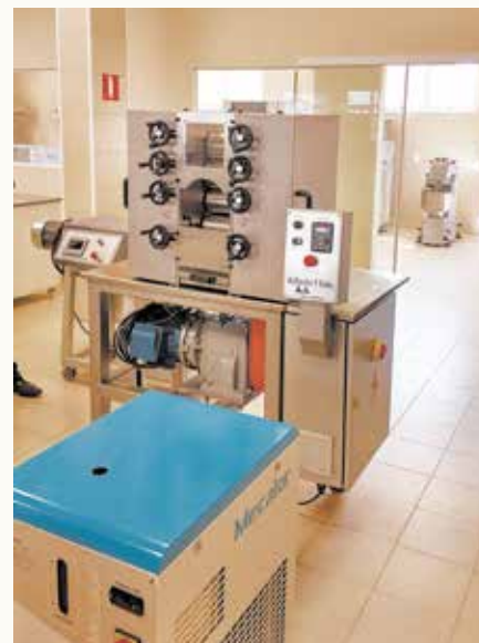
CENTRO DE APLICAÇÕES PLANTA-PILOTO DE CHOCOLATE CONTA COM REFINADORA DE ROLOS.
