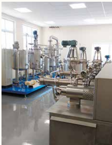
CENTRO DE APLICAÇÕES PLANTA-PILOTO DE CHOCOLATE CONTA COM REFINADORA DE ROLOS.
