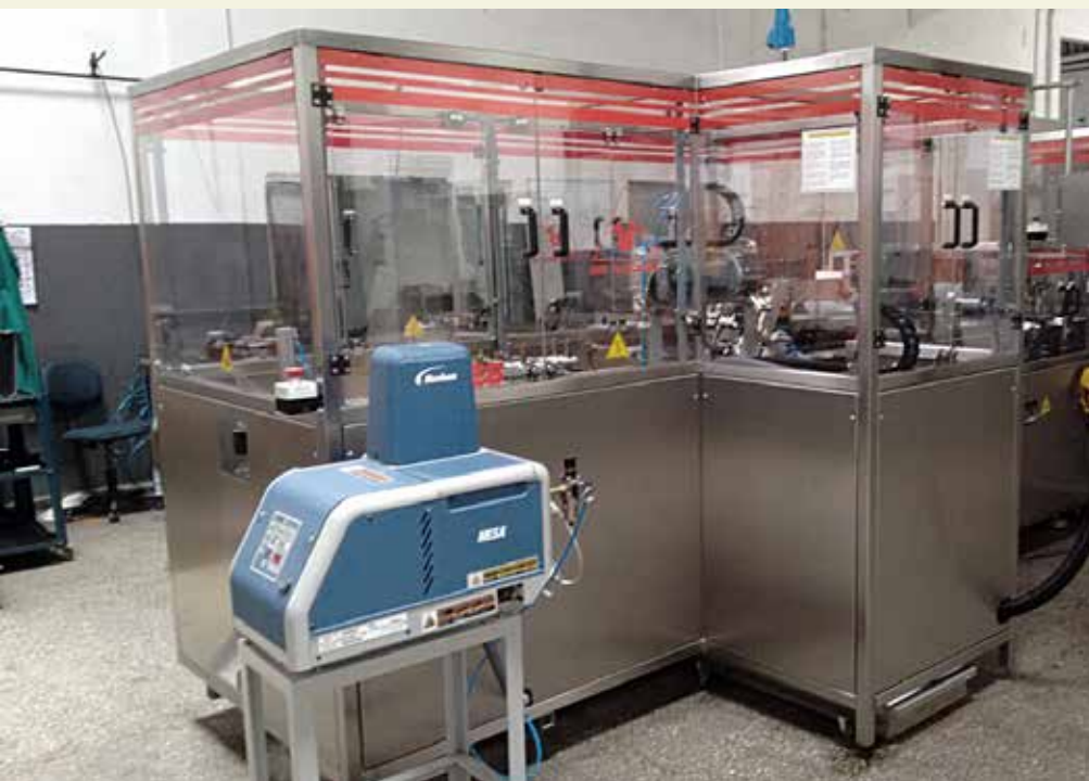
LINHA ENCARTUCHADEIRA PROJETO DA ARV PARA BARRAS DE CHOCOLATE E DE CEREAIS.
