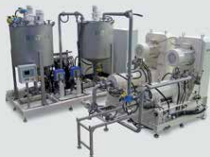
SALSA - Moagem fina a úmido em operação contínua em um moino agitador de esferas tipo LME
