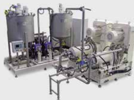
S454 - Moagem Fina a úmido em operação contínua em um moinho agitador de esferas tipo LME
