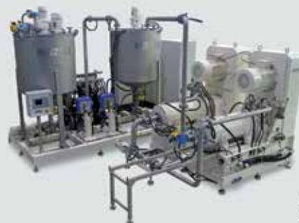
SALSA - Moagem fina a úmido em operação contínua em um moinho agitador de esferas tipo LME
